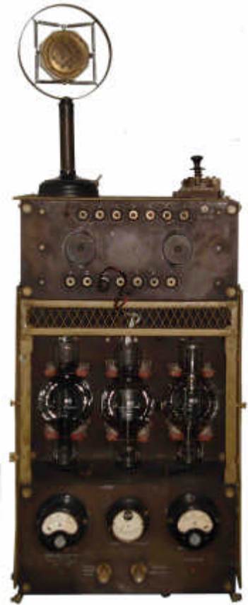
Un trasmettitore a tre valvole dei tempi di Marconi
